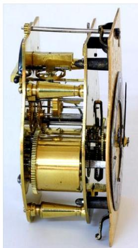
Il quadrante ha anello orario in ottone argentato, il semi-quadrante in alto per la regolazione della spirale del bilanciere; suona le ore al passaggio su campana collocata nel "cappello" della cassa. (*Jacques Nève*)
