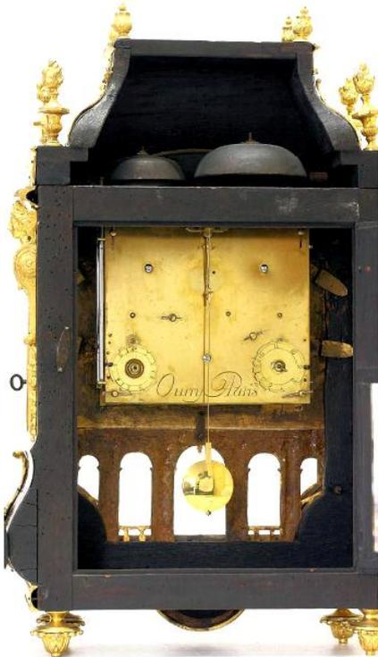
Il movimento è dotato di 3 treni: oltre a quello centrale per la funzione oraria, a destra per la suoneria dei quarti su due campane, a sinistra per la suoneria delle ore su un'altra campana. Due diverse ruote partitore regolano la suoneria.
