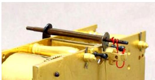
Ad ore 12 un’apertura permette ad una chiave di regolare la lunghezza del filo del pendolo. Questo rappresenta un sistema insolito per l’epoca ed è precursore della rotella che sarà poi usata in epoca successiva.
