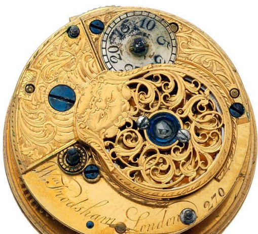
Figura 1 Movimento di orologio con scappamento a cilindro circa 1780. Firmato William Frodsham (1728-1807) Red Lion Square, è probabilmente un parente del William del ritratto successivo e padre di Charles.
