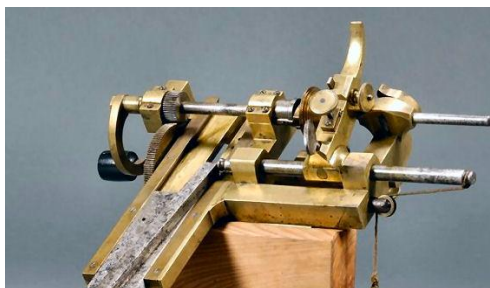
Figura 8 Macchina per la costruzione del conoide simile a quella descritta, ma di probabile fabbricazione svizzera.
