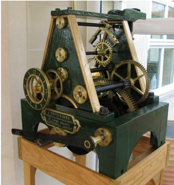
Figura 13 Movimento d'orologio per edificio civile. La società vanta una lunga esperienza nella fabbricazione di questo tipo d'orologi anche per uso religioso.
