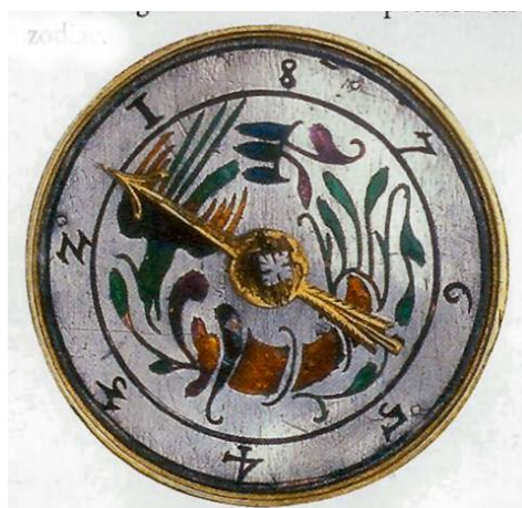
Da 1 a 8 distanza le setole che regolano l'oscillazione del bilanciere.
