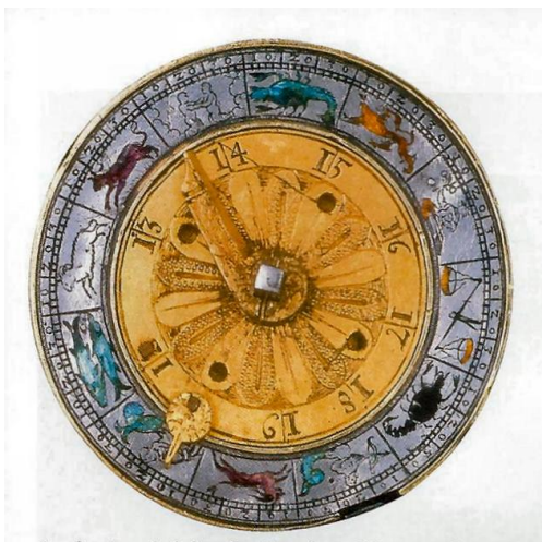
Per settare le ore di Norimberga, sul cerchio esterno indica la posizione del Sole nello Zodiaco.
