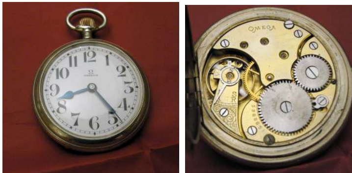
Figura 16 Orologio Omega per uso ferroviario, anno 1922, con bilanciere bimetallico, tagliato e compensato.
