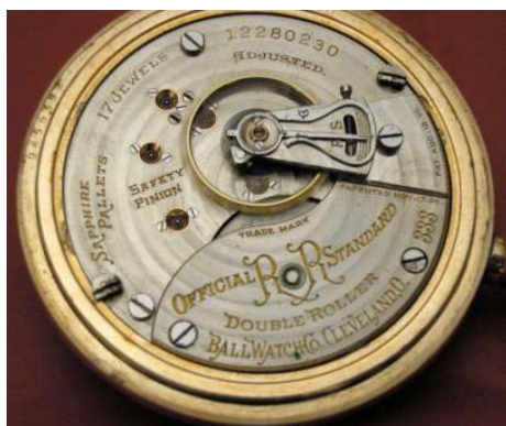
Figura 15 Movimento di orologio Ball del 1906 rispondente agli standard Rail Roads americani. Basato su movimento 333 della Elgin
