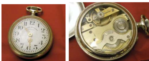
Figura 20 Dai numeri arabi di grandi dimensioni su quadrante bianco, si suppone il richiamo commerciale dell'uso ferroviario per un Roskopf anni '30 con qualche raffinatezza costruttiva in più rispetto agli orologi d'uso popolare
