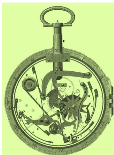
Alcuni schemi di meccanismi di antiche ripetizioni: 1 meccanismo in attesa; 2 meccanismo pronto ai rintocchi; 3 Treno e martelletti pronti al suono.
