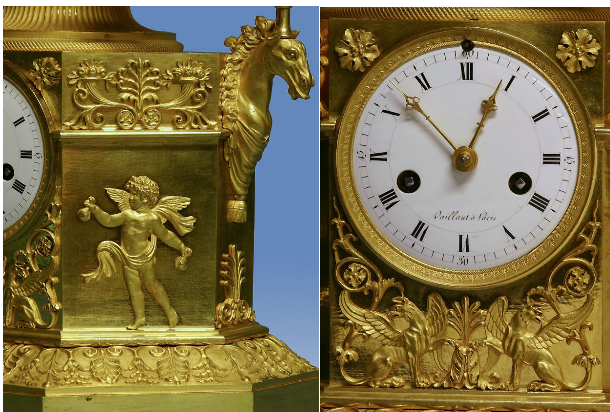
Figura 22 1810ca. Pendola Primo Impero, molto rara in quanto le pendole con animazione furono più frequenti nel periodo successivo (Carlo X). Questa è firmata "Vallent à Paris" ed ha sospensione a filo, carica 8 gg, suona ore e mezze. Al rintocco dell'ora la giostra si mette in moto automaticamente ma il movimento può anche essere comandato manualmente da una leva sulla base. L'automazione ha una carica separata che consente un'autonomia di 12 ore.
