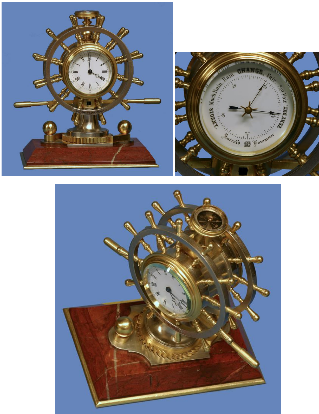
Figura 13 Cassa francese per un orologio che porta inciso il nome di Jules Jurgensen. E' probabilmente suo il movimento di qualità con 8 gg di carica, il barometro porta la firma AER (Antoine Redier) noto costruttore francese di barometri. L'orologio è montato su di una base in marmo rosso ed un dispositivo a cricchetto consente di ruotarlo per mostrare, alternativamente, l'ora od il barometro.
