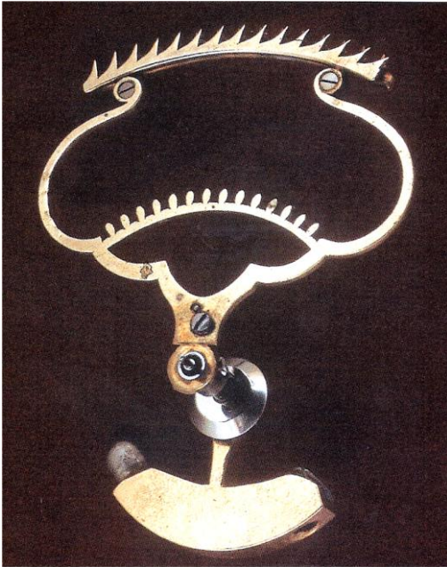
La foto mostra il settore con la dentatura di scappamento e quella dei secondi.
