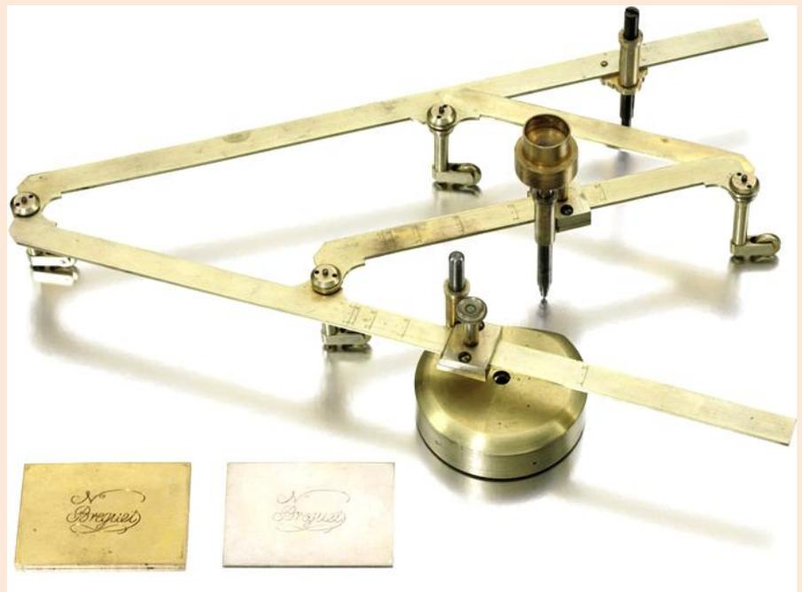
*Il pantografo con punta di diamante di Breguet utilizzato per tracciare la firma segreta. Veniva applicata per proteggere il marchio dalle numerose imitazioni. A volte riportava anche il numero seriale dell'orologio.*
