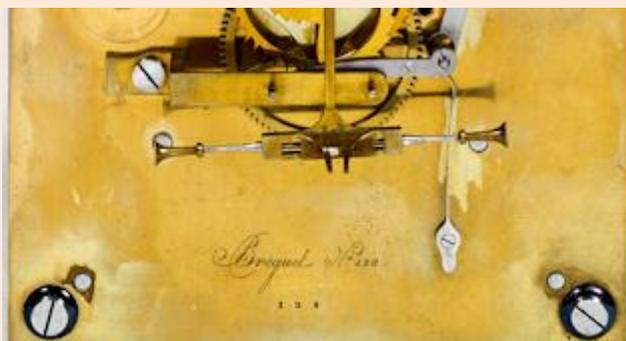
*Il pendolo compensato della Pendule n° 128, il particolare della platina posteriore con il numero seriale, il monogramma di Ferdinando Filippo d'Orleans.*
