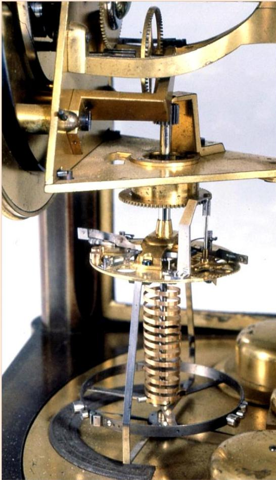
Come si legge anche su questo scappamento, utilizzato nella quasi totalità delle *Pendule Sympatique* di Breguet, Claudius Saunier esprime il suo dissenso arrivando anche a criticare lo spessore della *limaçon B* nel disegno.
