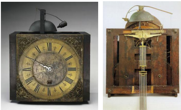
Figura 7 Primo orologio di Harrison. costruito in legno per evitare la lubrificazione, mosso da pesi e dotato di pendolo era destinato ad una cassa da pavimento
