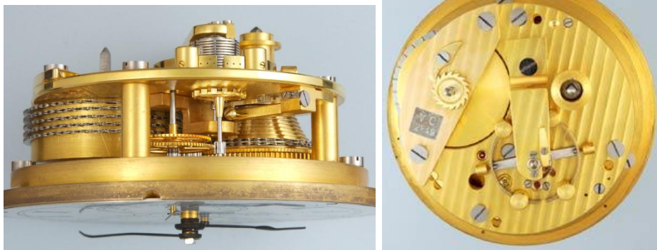
Figura 19 Tipico cronometro da marina firmato Vacheron & Constantin, in cassa di mogano con angoli e maniglie in ottone. Quadrante con due quadratini supplementari per i secondi e per la riserva di carica. Movimento a carica posteriore (si carica ribaltandolo nella cassa), bilanciante bimetallico con pesi e viti di regolazione del tempo. Molla del bilanciante elicoidale, scappamento cronometro (Earnshaw spring detent). Circa 1910.
