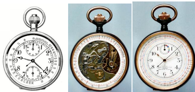
Figura 29 Quadrante con scala tachimetrica in miglia, e raro orologio con doppio quadrante. In quello ad anello calcola la velocità in Km/ora, nell'altro la calcola in miglia (e frazioni)/ora.
