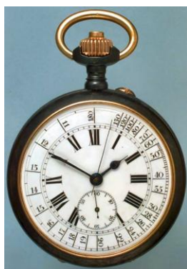
Figura 31 Orologio in acciaio brunito con funzione cronografo e scala per misurare le pulsazioni.
