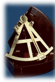
Figura 2 Sestante di Hadley per il calcolo della latitudine (1730 circa) usato per misurare l'altezza degli astri
