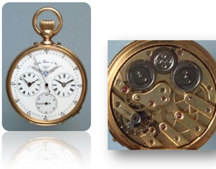
Figura 21 Orologio di fabbricazione svizzera con doppio quadrante orario e secondi indipendenti, l'indicazione, nel quadrante a sinistra, delle ore con caratteri turchi è chiaramente indicativo dell'uso per indicare l'ora di due diverse regioni.
