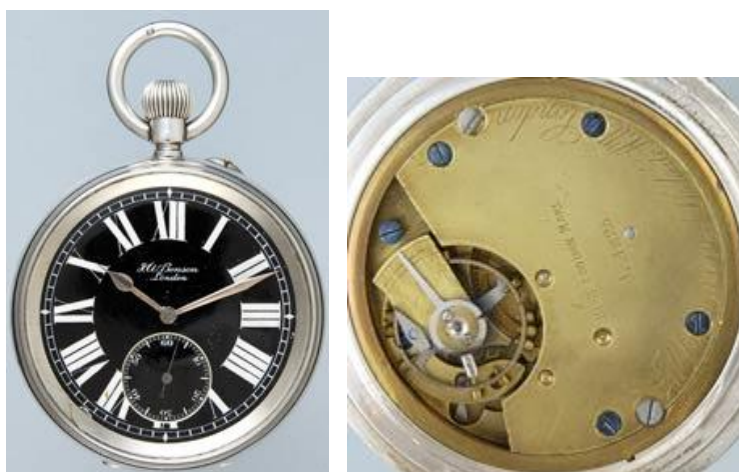
Figura 26 Orologio in cassa d'argento firmato: J W Benson , quadrante nero, movimento ancora con bilanciere compensato, fondello cassa marchiato con la freccia , numero e HMS. Marchi argento 1922
