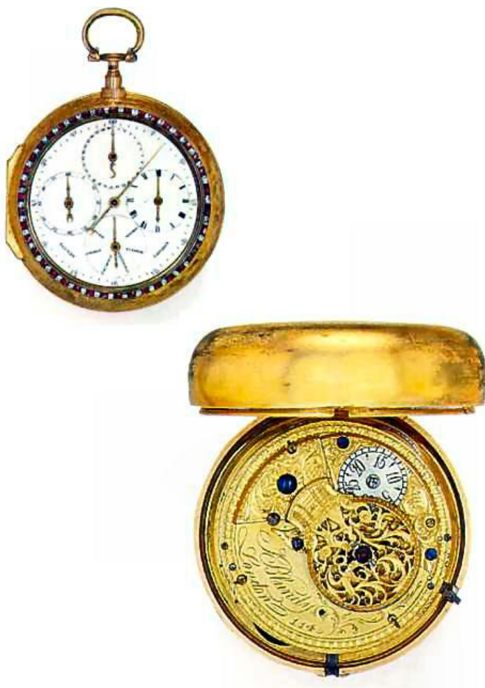
Joseph Blundy , London, circa 1790. Orologio da carrozza fabbricato per i mercati orientali. Astronomico senza ripetizione e sveglia. (raro negli orologi da carrozza). Il quadrante, di tipo regolatore, ha quattro quadranti ausiliari che indicano: a destra le ore, a sinistra i minuti, ad ore 12 il mese lunare, ad ore 6 il giorno della settimana ed un'altra indicazione dei secondi oltre a quella centrale. Ad ore 8 un pulsante sulla cassa attiva la funzione di stop della sfera centrale dei secondi. Il cerchio orario è ornato con pietre color rubino. Il movimento, 60 mm, ha scappamento a verga e rubino sull'asse del bilanciere a tre bracci. Diam. 85 mm.
