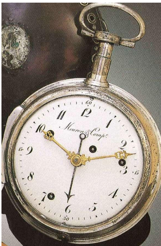
Meuron & Comp. , (Svizzera), circa 1790. Cassa in argento, controcassa ricoperta in tartaruga, Grande Sonnerie, ripetizione ed allarme. Scappamento a verga, treno delle ore indipendente dai quarti, sveglia a carica indipendente, ripetizione attivata da cordino. Tutte le funzioni sonore su campana. Diam. 135 mm.
