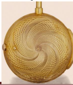
Figura 8 Esempio di cassa lavorata 'a canestro' utilizzando il tornio.
