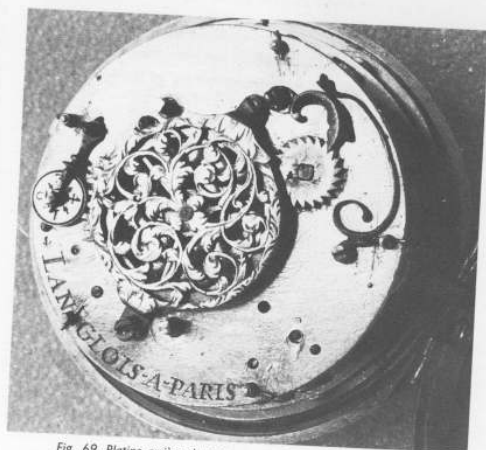
Fig. 69. Platine arrière du mouvement de la montre de Langlois. On peut noter la conservation du cliquet d'armage du ressort-moteur, à côté de la rosette de réglage du spiral.
