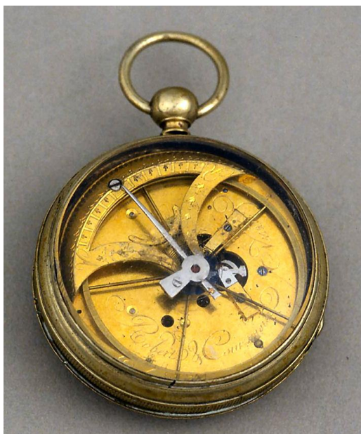
Figura 18 Un orologio particolare, dotato di un grande bilanciere che aziona lo scappamento ad ancora modificato da Jean Moïse Pouzait (1743 – 1793). Pouzait è ricordato per l'invenzione dei secondi indipendenti che originò la moderna cronografia.
