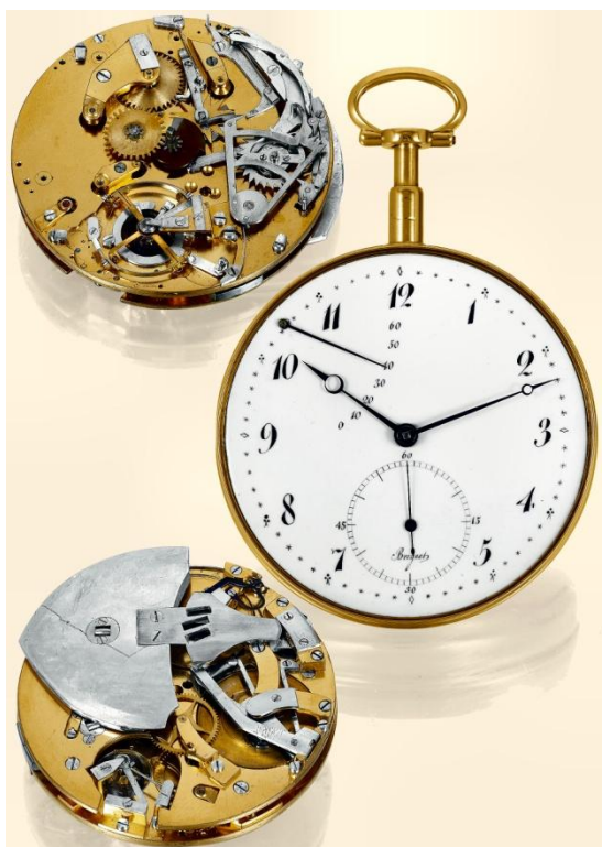
Figura 23 Il 'perpetuelle' n°15 di Breguet del 1793, è dotato di varie delle complicazioni ricordate in questo capitolo: carica automatica con massa oscillante, ripetizione di quarti à toc, indicatore di riserva di carica per 60 ore, scappamento ad ancora.
