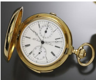
Figura 4 Orologio del 1810 circa a ripetizione ore e quarti azionata premendo il pulsante, notare la speciale chiavetta che, consentendo di caricare l'orologio in una sola direzione, evitava danni al movimento.
