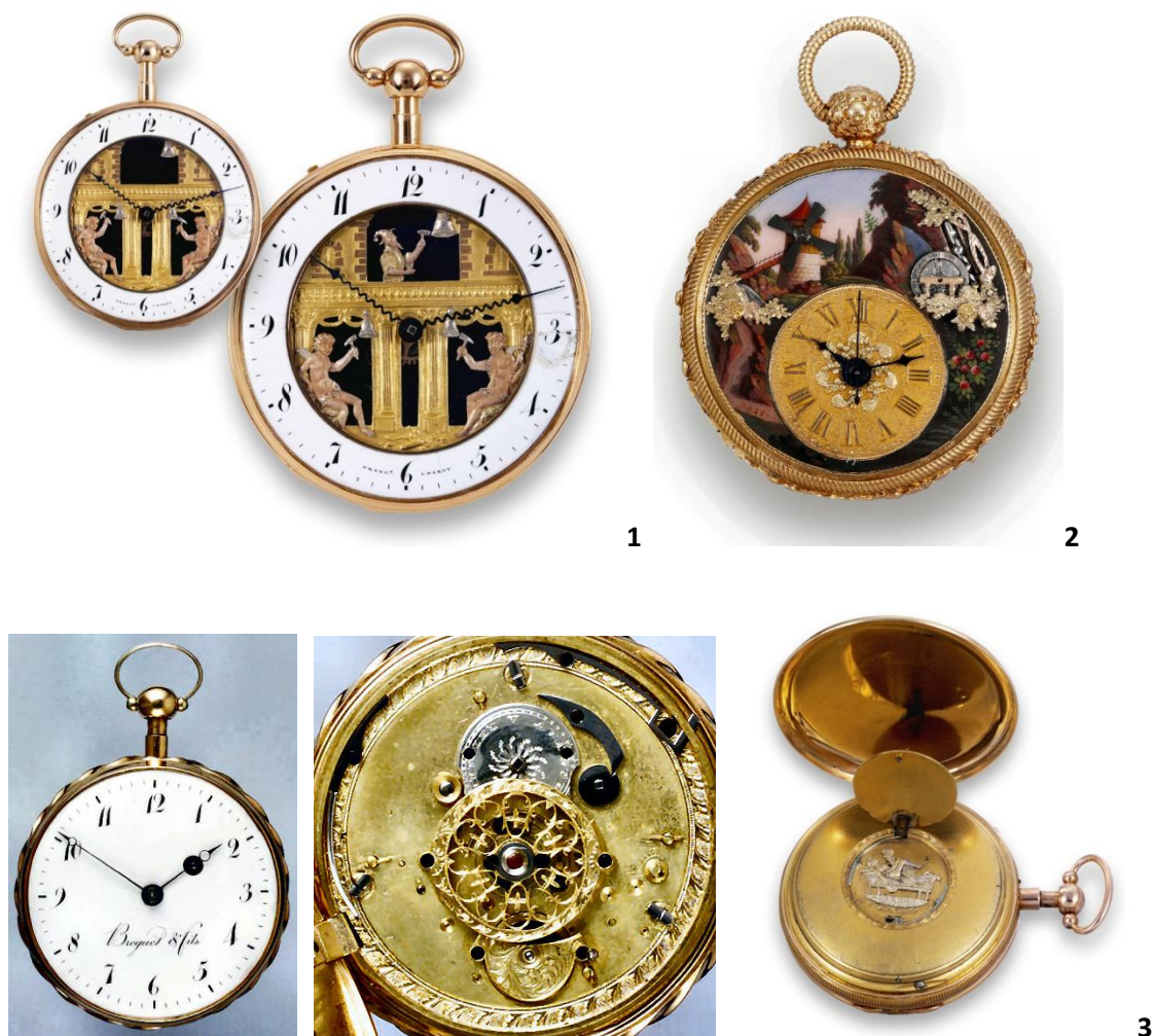
Figura 7 Gruppo di figure: 1) ripetizione detta 'jacquemart' con automazione, i campanaro in alto compare per suonare l'ora mentre gli altri due personaggi mimano i rintocchi dei quarti; 2) orologio con due automazioni (le pale del mulino e la ruota della macina a destra); 3) orologio in oro 1820 circa a firma Breguet & fils (certamente apocrifa) nella cuvette uno sportellino cela una scena erotica 'automatizzata' dalle oscillazioni del bilanciere.
