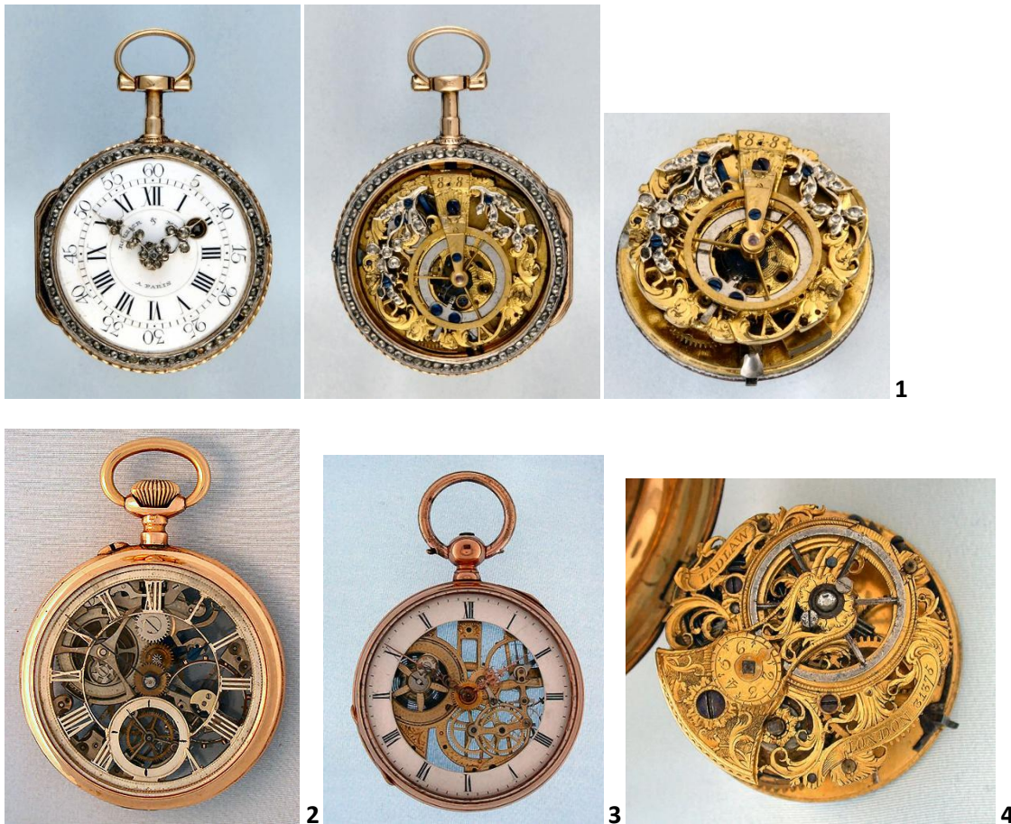
Figura 22 Con il n°1 un orologio francese (1780 circa) con scappamento a cilindro e movimento scheletrato e con diamanti inseriti sia sul movimento che sulla cassa; il 2 ed il 3 sono movimenti svizzeri di fine '800, mentre il n° 4 è un movimento inglese di metà '800.
