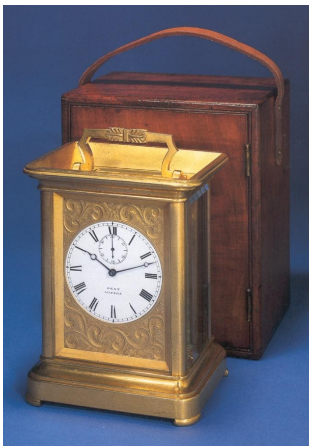
Figura 12 Officier di E. John Dent, circa 1840, dimensioni 18 x 13,5 x 11 cm, carica 8 giorni e suoneria ore; scappamento cronometro di Earnshaw con spirale cilindrica e diamante sull'asse.
