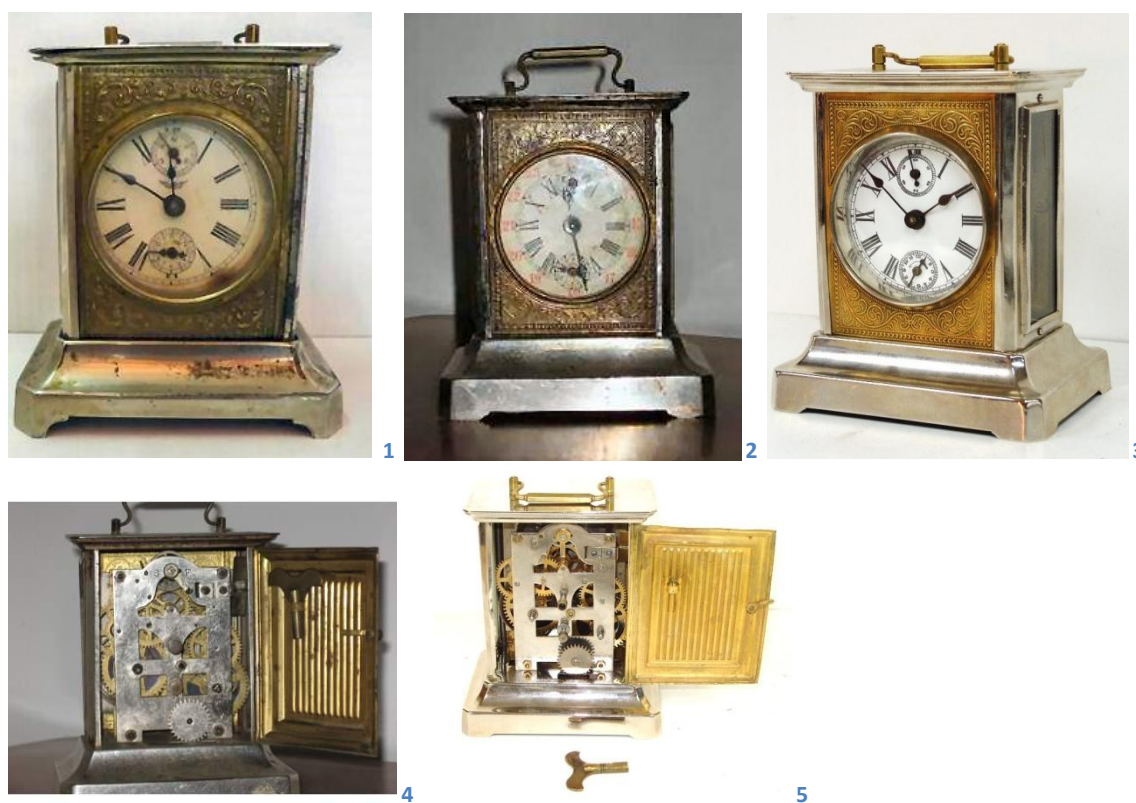
Figura 26 Tre diverse ma simili sveglie, di fabbricazione tedesca, dotate di un carillon alloggiato nella base. La numero 3, per le sue eccellenti condizioni (foto 5 il movimento) viene oggi venduta come officier ed a prezzi, di conseguenza, alti.
