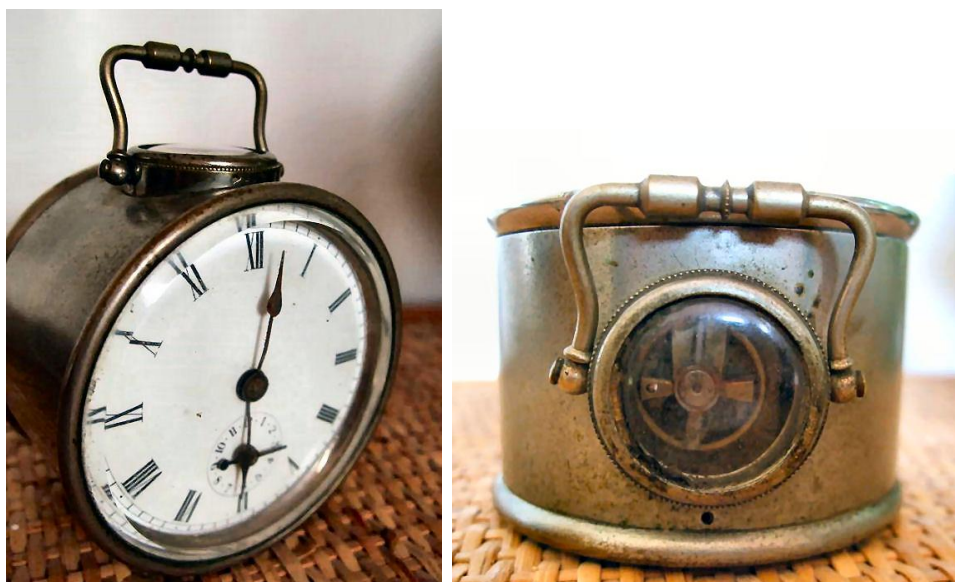
Figura 39 Orologio francese di forma a tamburo con scappamento ad ancora visibile nella parte superiore.
