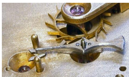
Figura 19 La foto 1 mostra il movimento senza la platina con i ruotismi sveglia, tempo, ripetizione. La foto 2: la piattaforma (color argento) dello scappamento ad ancora inglese (come si può notare nelle foto successive). Questo avrebbe potuto essere anche a cilindro o ad ancora svizzera.
