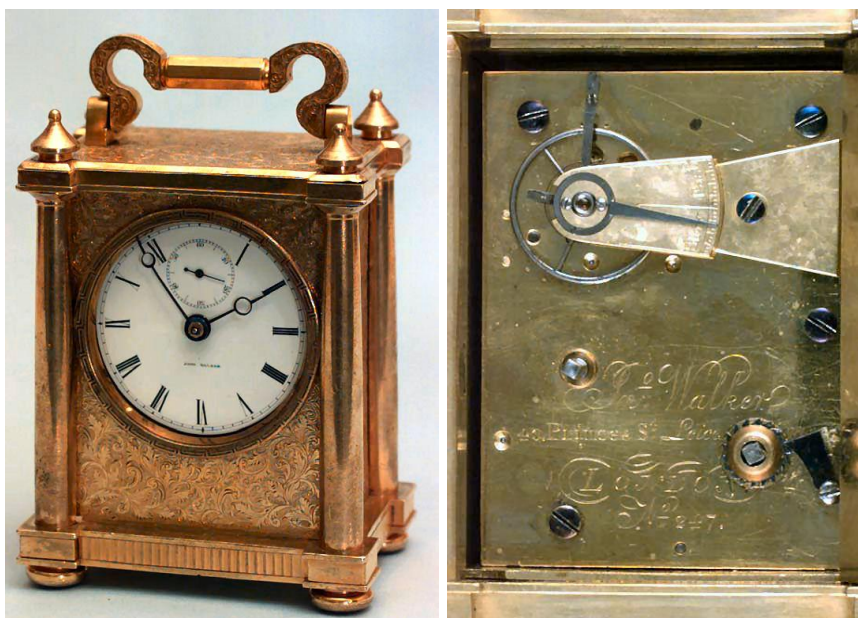
Figura 7 Altra officier inglese del 1837, firmata John Walker London; notare la posizione della piattaforma del bilanciante.
