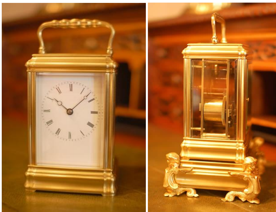
Figura 9 Un'altra pendola inglese, cassa 'Gorge', con l'insolito piedistallo per utilizzarla anche come orologio d'appoggio. Anche questa con scappamento ad ancora.
