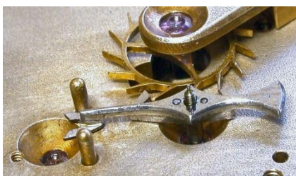
Figura 16 La foto 1 mostra il movimento senza la platina con i ruotismi sveglia, tempo, ripetizione. La foto 2: la piattaforma (color argento) dello scappamento ad ancora inglese (come si può notare nelle foto successive). Questo avrebbe potuto essere anche a cilindro o ad ancora svizzera.
