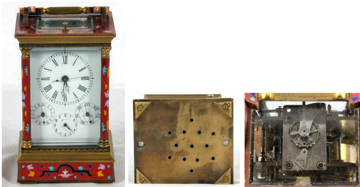
Figura 12 Officier made in China dotato di calendario e sveglia. Decorazione e qualità del materiale impediscono ogni confusione con orologi di 'stile cinese' fabbricati in Francia verso la fine dell'800 come quella della figura successiva.
