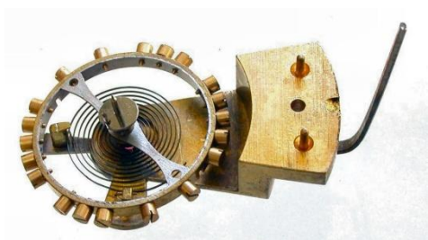
Figura 16 La foto 1 mostra il movimento senza la platina con i ruotismi sveglia, tempo, ripetizione. La foto 2: la piattaforma (color argento) dello scappamento ad ancora inglese (come si può notare nelle foto successive). Questo avrebbe potuto essere anche a cilindro o ad ancora svizzera.
