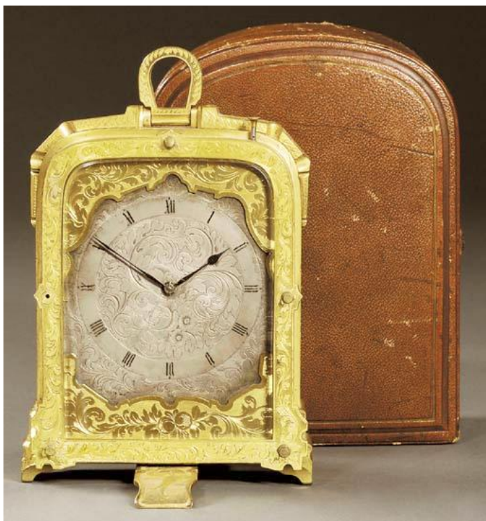
Figura 6 Officier in bronzo dorato firmato Whistler, London. Circa 1860. La platina riporta la scritta WHISTLER Fecit LONDON . Suona ore e quarti su gong ed ha la ripetizione. Scappamento ad ancora. Altezza 15,5 cm. Il quadrante in argento inciso ricorda gli orologi da tasca del periodo.
