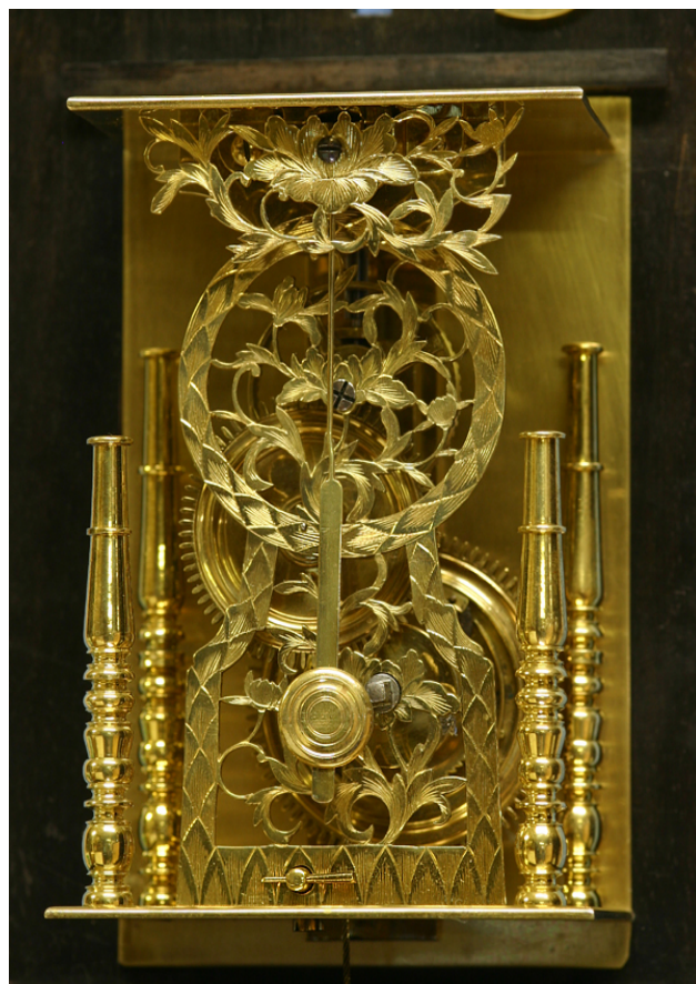
Illustrazione 27: pendolo con lente regolabile e platina riccamente decorata.
