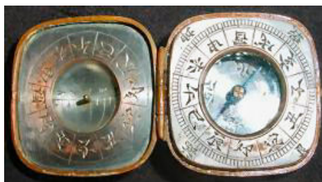
Illustrazione 5: Meridiana e bussola usata in navigazione
