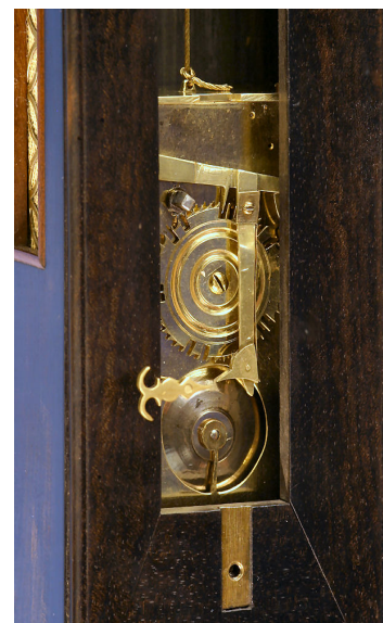
Illustrazione 25: bariletto di carica della suoneria e peso motore.
