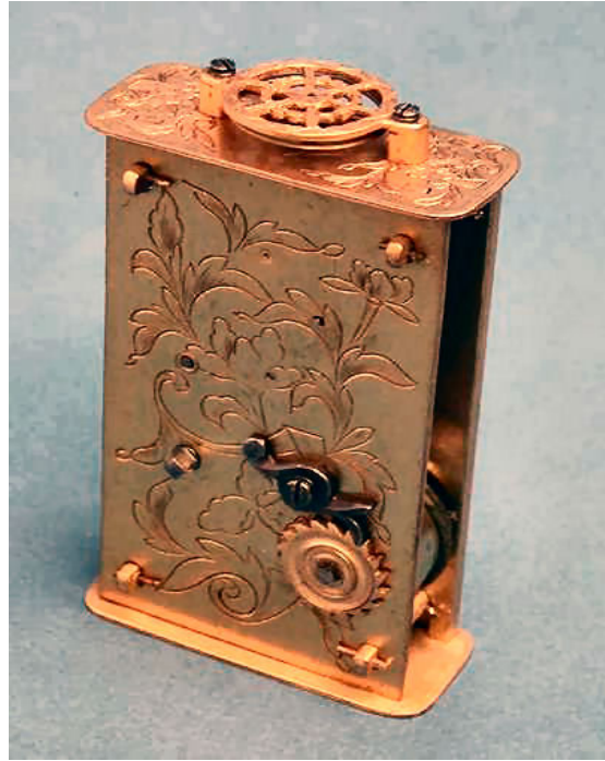
Illustrazione 37: Particolare del cricchetto di carica e del coq del bilanciante
