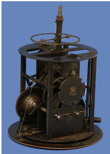
Illustrazione 13: movimento con ruota spartitora
