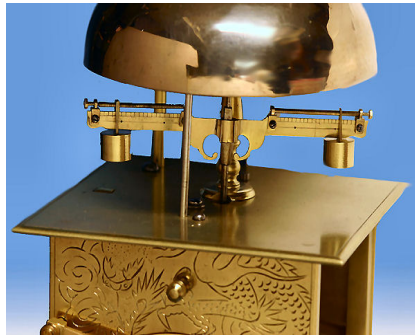
Illustrazione 22: particolare del foliot
